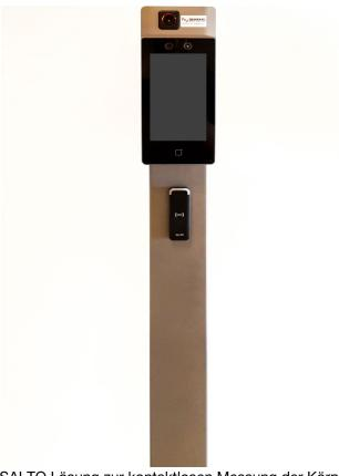
SALTO Lösung zur kontaktlosen Messung der Körpertemperatur und Maskenerkennung in Kombination mit elektronischer Zutrittskontrolle für Bereiche mit vielen Personen. Bildquelle: SALTO Systems/Beweng Security Solutions
